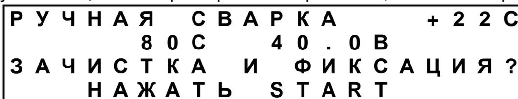
**ЗАМЕЧАНИЕ:** После нажатия кнопки START программа проверяет сопротивление фитинга и сопоставляет его с введенным напряжением и временем. Если сопротивление слишком мало, программа делает вывод, что мощность будет слишком высокой, и отображает отказ: «СОПРОТИВЛЕН. ФИТИНГА НИЖЕ ДОПУСТ. ПРЕДЕЛА».
