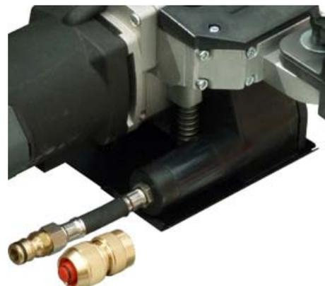
Чтобы использовать штроборез SC-125-U для сухой резки мягких материалов (кирпича, свежего бетона), систему подачи воды необходимо демонтировать.
