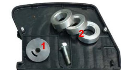
Снимите передний фланец крепления дисков (1) и три дистанционные шайбы (2) толщиной 13,2 мм каждая.
