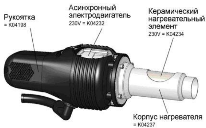
Комплектный термофен MEG-23, 230 V = K04202
