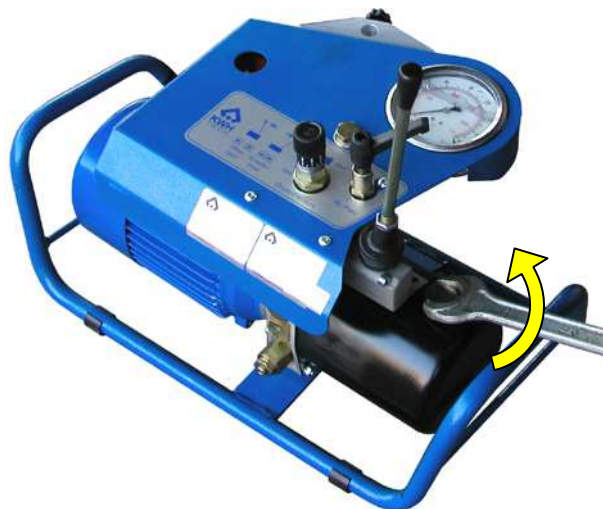
Рис.16 Замена заглушки на сопун
