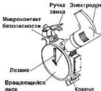
**Рис.6 Электроторцеватель машин PT 160 – PT 355**
