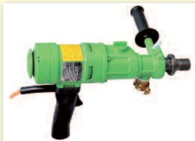
Для крепления буровых коронок к шпинделю электробормотора фирма Dr.Schulze GmbH (Германия) использует резьбовое соединение. Хвостовик коронок до  $\varnothing 50$  мм имеет наружную резьбу  $\frac{1}{2}$ " , от  $\varnothing 50$  мм и выше – внутреннюю резьбу  $\frac{1}{4}$ ". Поэтому шпindel электробормоторов небольшой мощности – комбинированный, с внутренней резьбой  $\frac{1}{2}$ " и наружной резьбой  $\frac{1}{4}$ ".
