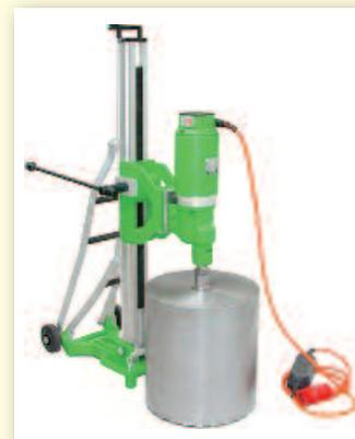
При сверлении отверстий средних и больших диаметров момент нагрузки на валу настолько высокий, что удержать электробормотор в руках крайне тяжело или невозможно. Поэтому для сверления буровыми коронками электробормотор крепится на станине с возможностью перемещения в направлении оси вращения буровой коронки.
