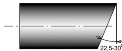
Рис. 28. Заготовка для второй операции производства Y-тройников
