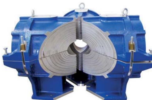
Рис. 15. Оснастка для сварки прямоугольных тройников
