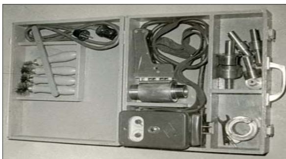
Рис. 8. Комплект для раструбной сварки Изготовитель: НИИМосстрой; диаметры: 20–40 мм
