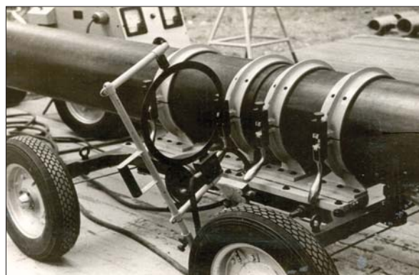
Рис. 2. Установка для сварки труб встык Изготовитель: ВНИИ гидротехники и мелиорации Диаметры: 110–315 мм
