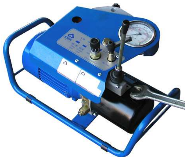
Рис. 4.1. Замена заглушки на сопун
