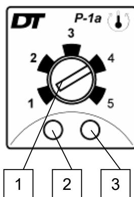
Настройка температуры в диапазоне 180–280°C производится с помощью поворотной кнопки (1) на панели управления. Шкала сварочного аппарата оснащена номерами 1–5, их положения приблизительно отвечают следующим температурам:
