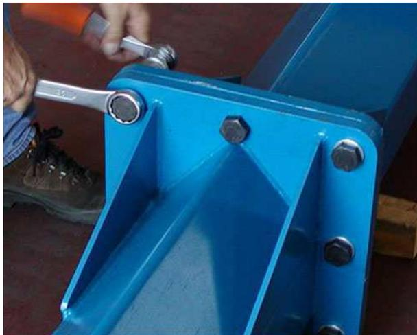
Когда стойка крана собрана, поднимите ее в вертикальное положение с помощью погрузчика, кран-балки или пр. Две монтажные площадки нижней половины стойки совпадут с монтажными площадками на раме центратора. Стяните их болтами.
