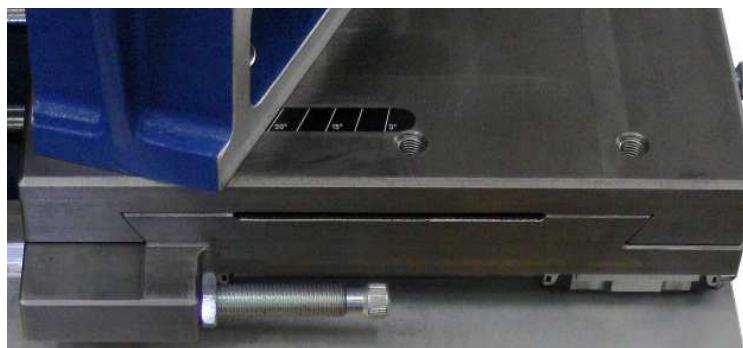
Рис. 15 Шкала регулировки угла поворота зажима
