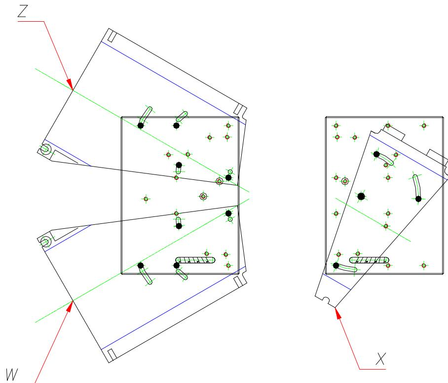
Рис. 26 Крепление зажимов для второго шва Y-тройников 60°
