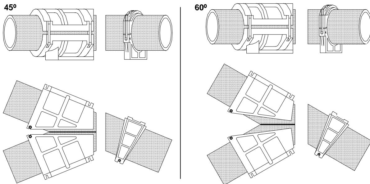
Рис. 27 Выполнение второго шва для Y-тройников
