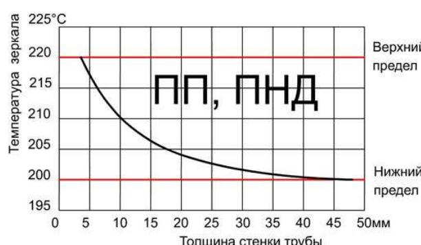
Рис. 10 Температура нагревателя для ПНД и ПП
