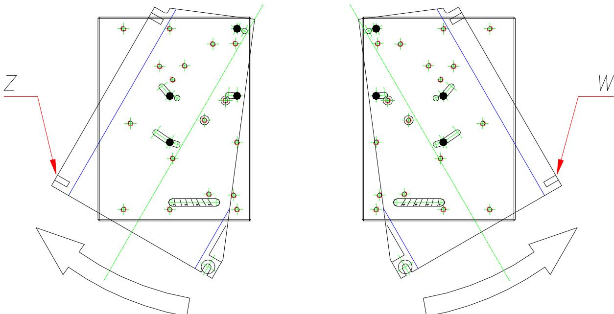
**Рис. 22 Крепление зажимов для первого шва Y-тройников 45° и 60°**
