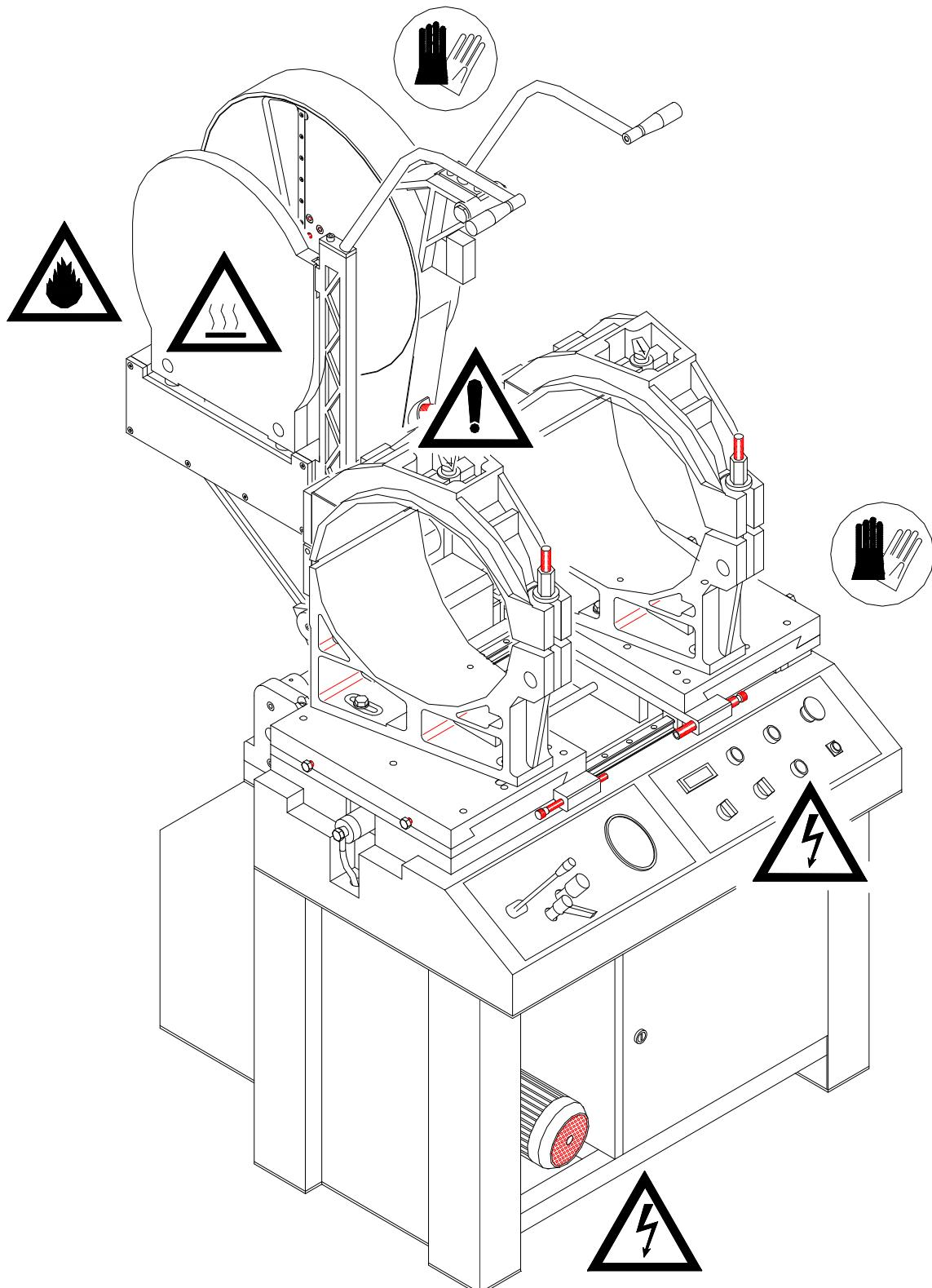
Рис. 1 Зоны потенциальной опасности машины PL 400 C
