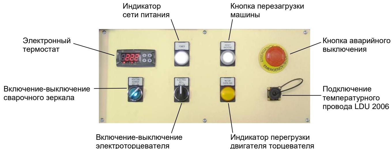
Рис. 8 Электрическая панель управления
