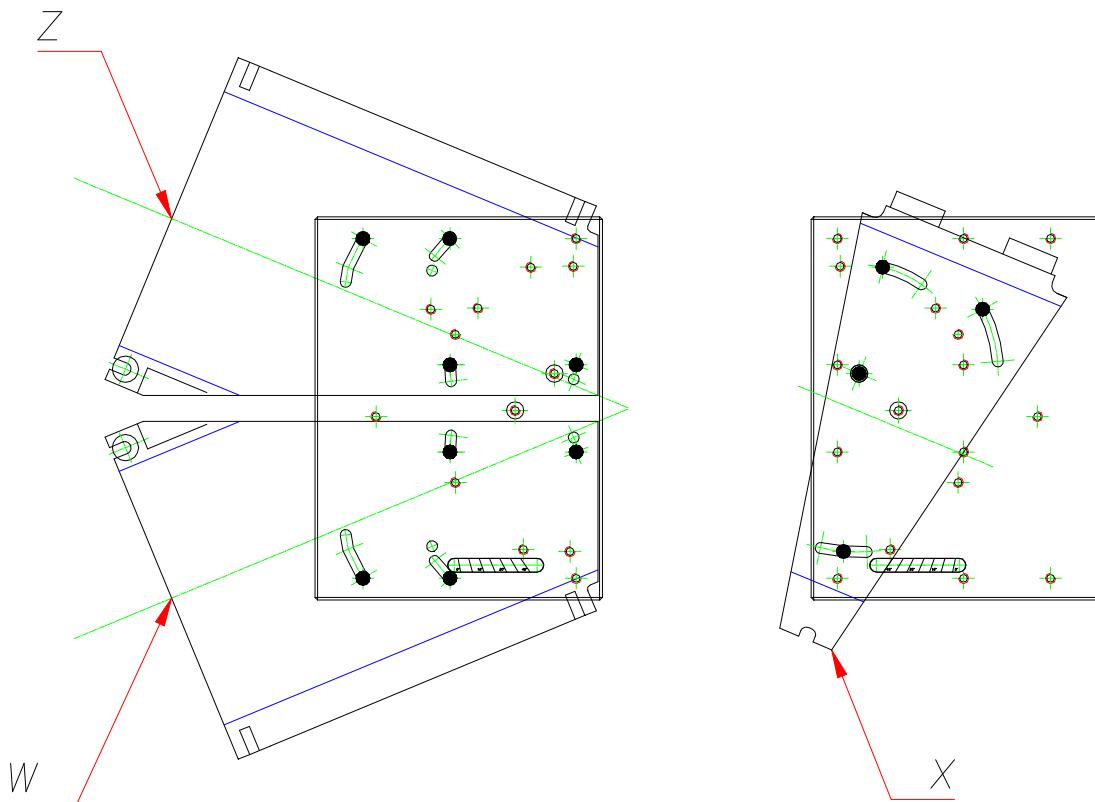
Рис. 25 Крепление зажимов для второго шва Y-тройников 45°
