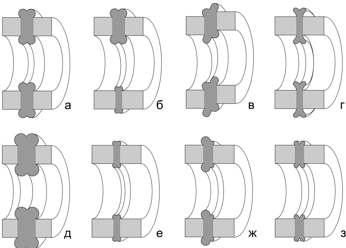
Рис. 12 Типичные ошибки при стыковой сварке
