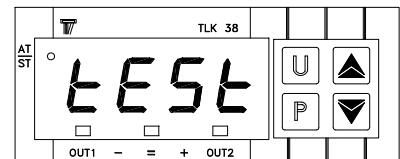
Если тестирование прошло неудачно, на дисплее отображаются 4 знака «тире» (см. рис. справа). Это обозначает, что контакт термостата с датчиком температуры или нагревательным элементом сварочного зеркала нарушен.
