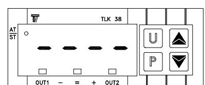
Если тестирование прошло успешно, дисплей отображает фактическую температуру сварочного зеркала, сварочное зеркало нагревается, и горит красный светодиод «OUT1». Когда фактическая температура зеркала достигнет заданной, красный светодиод «OUT1» гаснет, горит средний зеленый светодиод.
