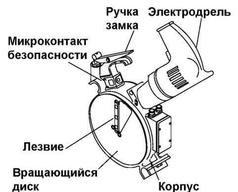
Рис. 3.2. Электроторцеватель
