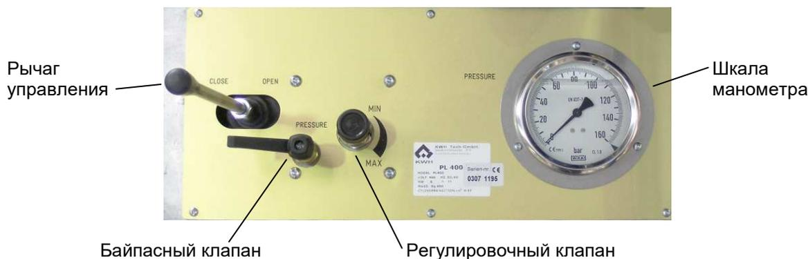
Рис. 11 Панель управления гидравлическим приводом
