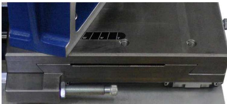
Рис. 15 Шкала регулировки угла поворота зажима
