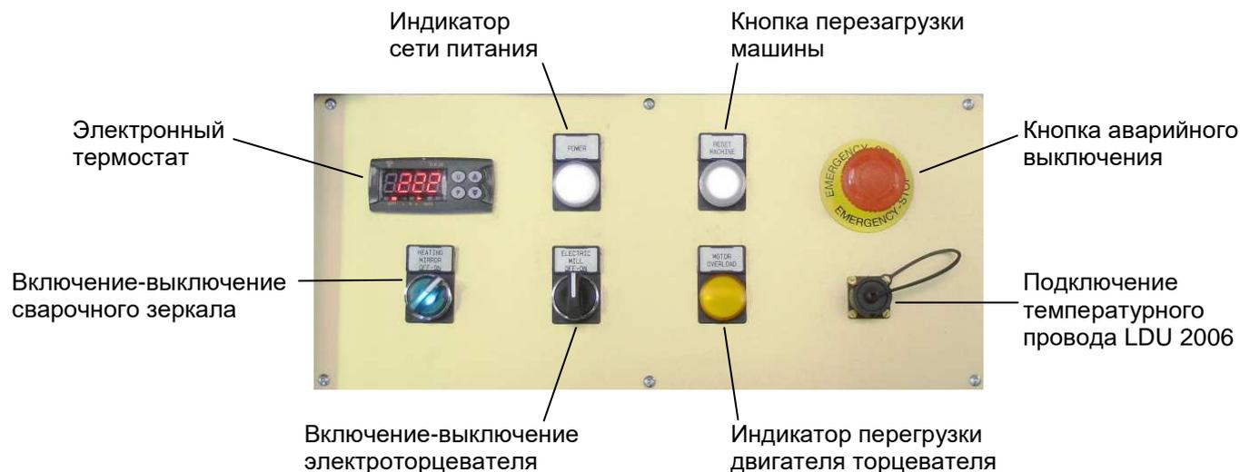
Рис. 8 Электрическая панель управления
