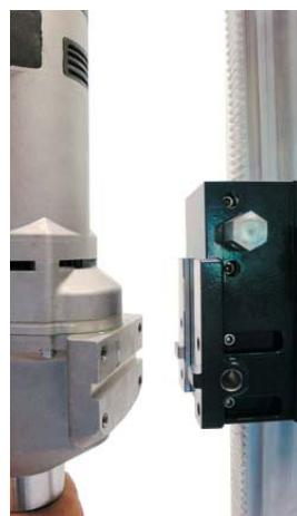
Еще один способ установки бормотора на станину Leonardo-300 или Leonardo-300V (только если корпус бормотора имеет монтажную площадку) – привинтить бормотор 4-мя болтами M8 непосредственно к каретке станины.
