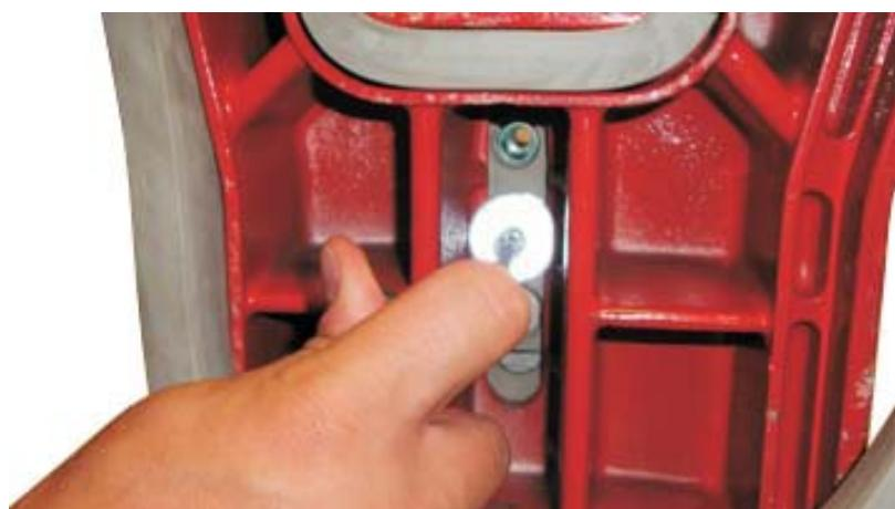
Установите вакуумную заглушку (входит в комплект поставки станины) в прорезь платформы с верхней стороны, предварительно убедившись, что на заглушке есть резиновая прокладка. Затем притяните заглушку снизу болтом с шайбой (входят в комплект поставки станины).
