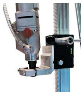
Если на станину Leonardo-300 или Leonardo-300V необходимо установить бормотор без монтажной площадки, то вместо штатной необходимо использовать специальную пластину быстросъемного крепления с хомутом Ø60 мм (опция), которая крепится к каретке станины таким же образом.
