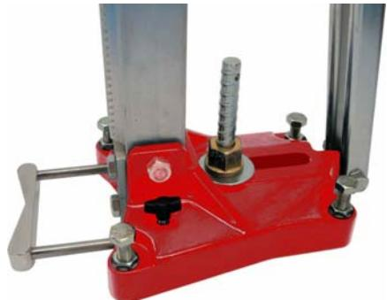
**ВНИМАНИЕ!** Если твердая основа покрыта сравнительно мягким декоративным покрытием (туф, ракушечник и т.п.), анкерный дюбель необходимо устанавливать глубже, в твердую основу. В этом случае стандартного анкерного болта длиной 160 мм может быть недостаточно, используйте болт длиной 210 мм.
