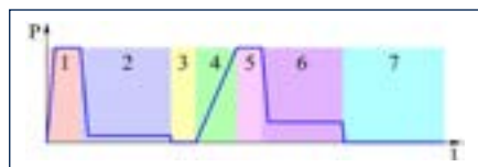
Рис. 5. Циклограмма процедуры сварки при двойном низком давлении Стадии сварочного процесса: 1 – выравнивание, 2 – прогрев, 3 – технологическая пауза, 4 – подъем давления, 5 – сварка, 6 – охлаждение в машине под давлением, 7 – охлаждение вне машины Fig. 5. Dual low-pressure fusion jointing cycle Fusion process stages: 1 – initial bead-up, 2 – heat soak, 3 – heater plate removal, 4 – fusion pressure achievement, 5 – fusion, 6 – cooling in the machine under pressure, 7 – cooling out of the machine
