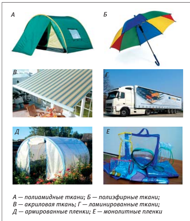
Рисунок 1. Типы технических тканей и пленок с примерами их применения
